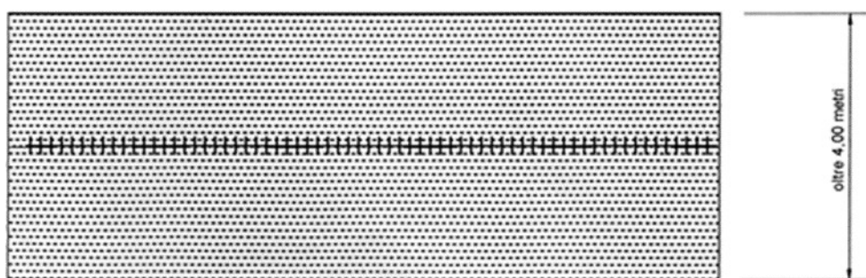
figura 14 scavo al centro della strada
